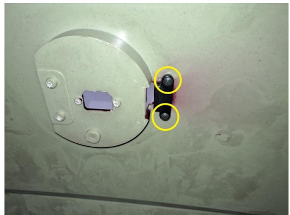
Irrota latausluukun kiinnitysruuvit (ristipäämeisseli ph2). Ota latausluukku irti takapaneelistä.
